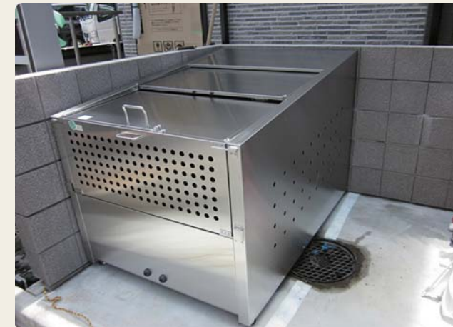
奥行きが長く間口が狭い集積場には、EMSのオーダーが適しています。奥行の長さの2/3が開口となるので、回収もしやすいです。
