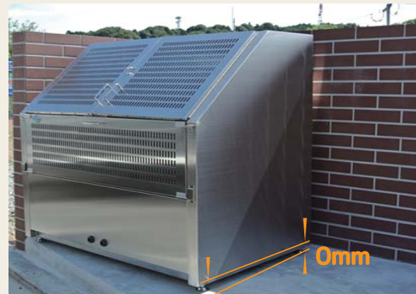
標準付属アジャストボルトは50mmです。 ボックス前後左右の設置可能な勾配は 0-25mm迄です。それ以上の勾配の場合は オプションのアジャストボルトで調整します。
