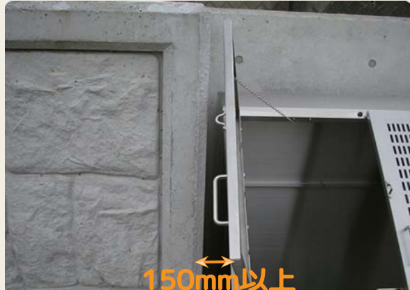
壁から150mm以上離して設置します。 チェーンで扉の開閉角度を調整すれば、 約80mmのスペースでも大丈夫です。 (EM2・13・14は隙間無しでも大丈夫です)
