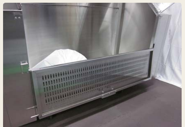
扉が手前に倒れて、内部に容易に入れます ので、清掃等の作業が簡単に出来ます。 (扉を閉める時は開けた時の手順と逆です)
